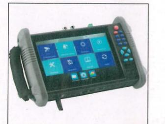
können auf einer SD-Karte gespeichert und vorhandene Daten am Gerät wiedergegeben werden. Neben RJ45-Anschlüssen, HDMI-Ein- und Ausgang sind auch BNC- sowie 3,5-mm-Klinken-Buchsen vorhanden.
