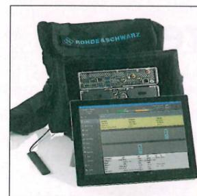
tomatischer Kanalerkennung ist schneller und empfindlicher als ein herkömmlicher Spektrumanalysator. Mit dem Gerät lassen sich 5G- und LTE-Tests parallel durchführen.
